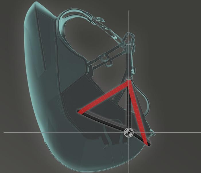
Vor der Landung streckt der Pilot die Beine aus und schiebt die Hüfte nach vorne. Dadurch kippt er automatisch in eine aufrechte, laufbereite Position. Dank Balance Strap System können die Hände an den Bremsen bleiben. Ein weiteres Plus an Sicherheit.
